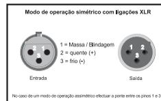
Na caso de um modo de operação assimétrico efectuar a ponte entre os pinos 1 e 3.
