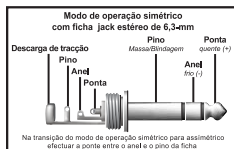
Fig. 5.3: Ficha jack estereo de 6,3mm
