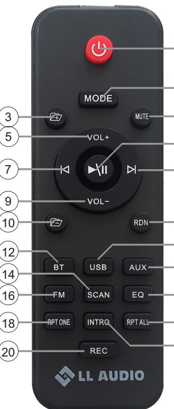
O Controle remoto permite operar de forma simples as funções do rádio e do reprodutor Mp3 em até 8 metros. Permite também ligar e desligar o amplificador colocando-o em stand by.
