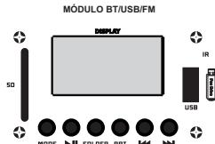
Este módulo possui rádio FM, reproduz músicas a partir de um PENDRIVE ou SD CARD. Conectando o teclado ao terminal MP3, WMA e WAV de forma simples e objetiva. Basta conectar o PENDRIVE ou cartão de memória na entrada USB/SDCARD e ele já começará a reproduzir os arquivos encontrados na ordem de gravação aparecerá "READ DEVICE" e logo em seguida haverá a reprodução.
